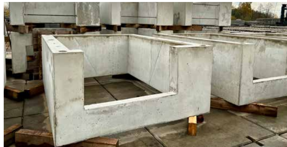
Prefabrykowane szyby windowe przygotowane do transportu
