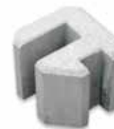
Łącznik narożny dla podmurówek Szerokość: 16,5 cm Długość: 22 cm Wysokość: 20 cm Otwór wewnętrzny szerokości: 6 cm
